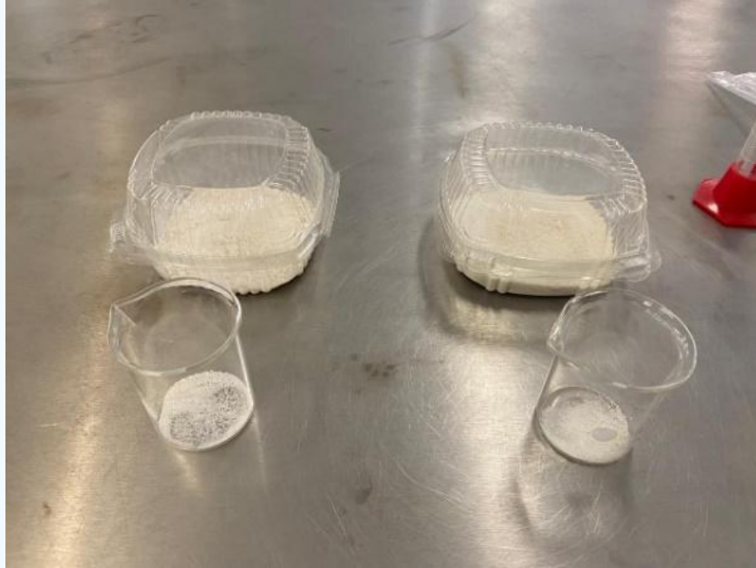
Figura 3. Imagen de las dos versiones de polímeros absorbentes, uno solo con almidón y metilcelulosa y el otro también con mucilago del nopal modificado.
